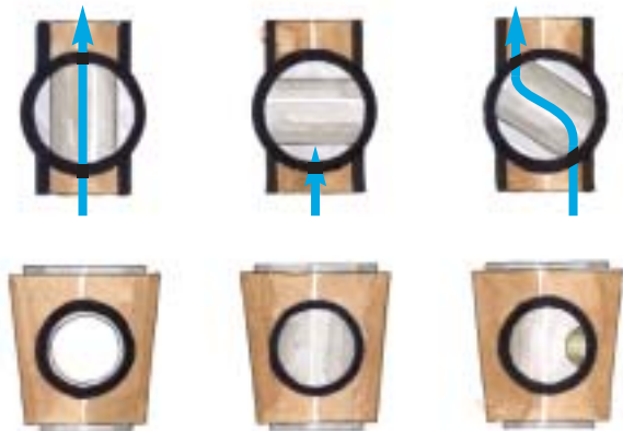
4 Trzy położenia zaworu kulowego: pełne otwarcie, zamknięcie, otwarcie częściowe; w rzędzie górnym przekrój pionowy, w dolnym – z boku
