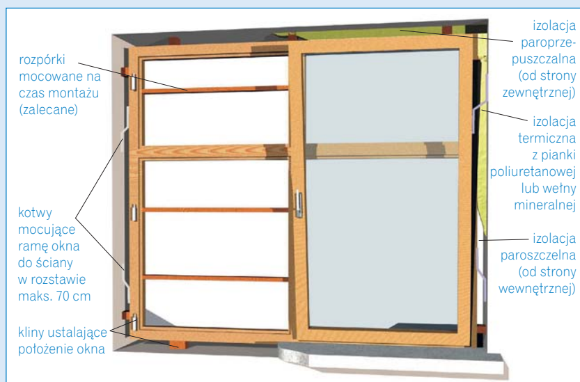
▲ Zasada montażu okna
