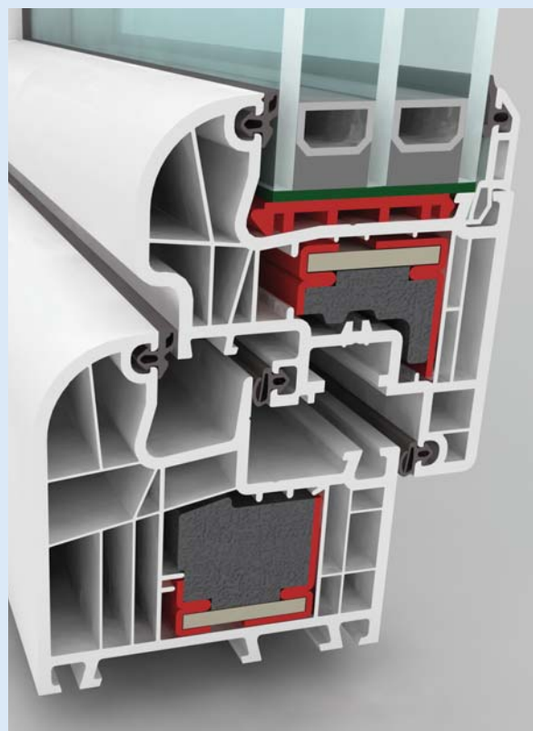
▲ Współczesne okno z sześciokomorowego profilu PVC z dodatkowym wypełnieniem termicznym, trzema uszczelkami obwodowymi i szybą zespoloną o współczynniku U_g=0,6 [W/(m 2 ·K)]
