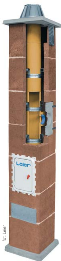
Komin z prefabrykatów. Rura ceramiczna poprowadzona wewnątrz pustaka z betonu lekkiego – elementy betonowe łączone na zaprawę cementowo-wapienną
