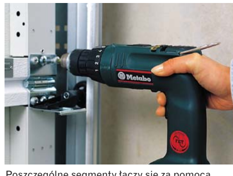
Poszczególne segmenty łączy się za pomocą blachowkrętów i odpowiednio ukształtowanych zawiasów w miejscu, w którym znajdują się wcześniej przygotowane fabrycznie otwory
