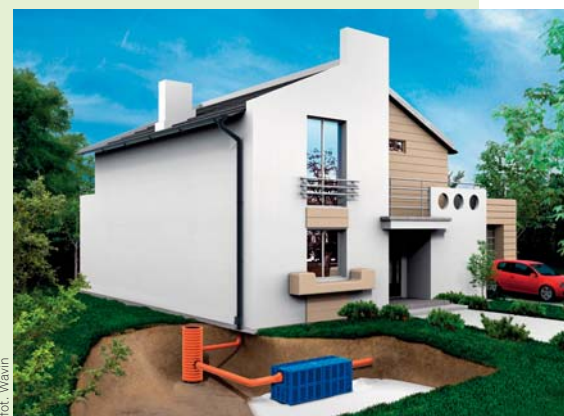
▲ Zbiornik retencyjno-rozsączejący układa się w wykopie na podsypce piaskowej lub żwirowej (o grubości min. 10 cm) i geowłókninie. Następnie owija się go geowłókniną (co zabezpiecza przed przedostawaniem się do wnętrza zbiornika gruntu) i zasypuje piaskiem lub żwirem
