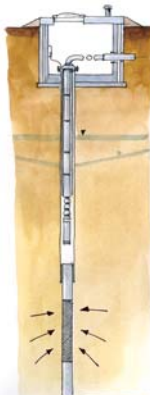
Studnia wiercona z pompą głębinową
