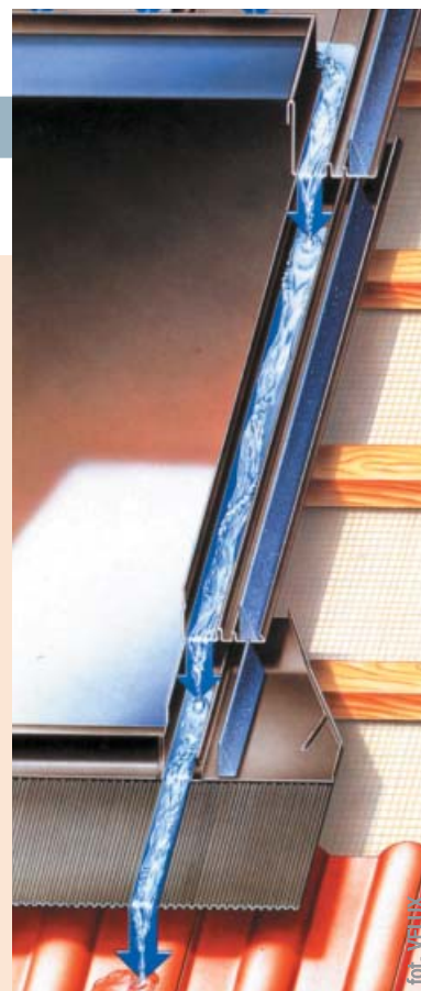
Poprawnie zamontowany kołnierz okna dachowego uchroni poddasze przed przeciekami
