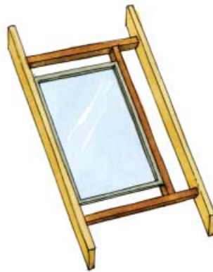
Zastosowanie wymianów – okno znacznie mniejsze lub większe od rozstawu krokwi
