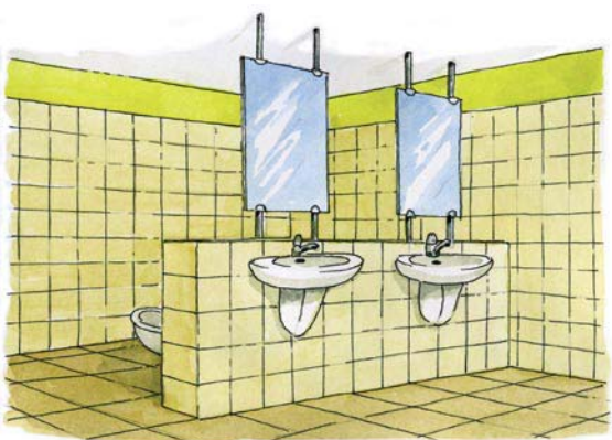
2 Niska ścianka w łazience, dzieląca i zawierająca stelaże do instalowania: umywalki z jednej strony, muszli i bidetu z drugiej
