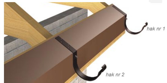
Haki montujemy od nr 1 do 10. Hak nr 1 będzie położony najniżej (bezpośrednio przy sztucerze).
