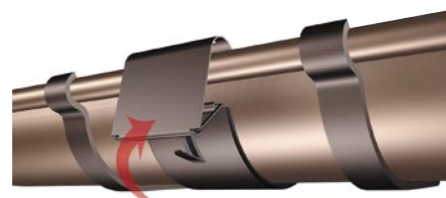
Złączkę zakładamy na łączone rynny i zatrzaskujemy. Pomiędzy rynnami należy zachować odstęp ok. 5 mm.
