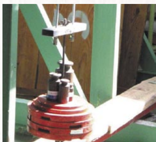
Stanowisko badawcze w Instytucie Techniki Budowlanej. Rozstaw haków - 1180 mm obciążenie - 750 N
