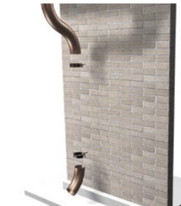
Rozplanowanie obejm rury spustowej
