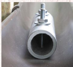
Stanowisko badawcze w Instytucie Techniki Budowlanej. Rozstaw haków - 1180 mm obciążenie - 750 N
