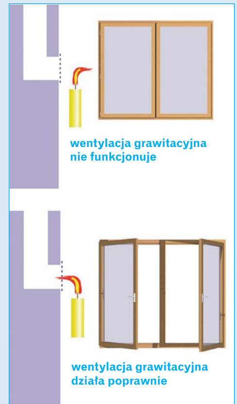
▲ Prosty sposób sprawdzenia poprawności działania wentylacji grawitacyjnej
