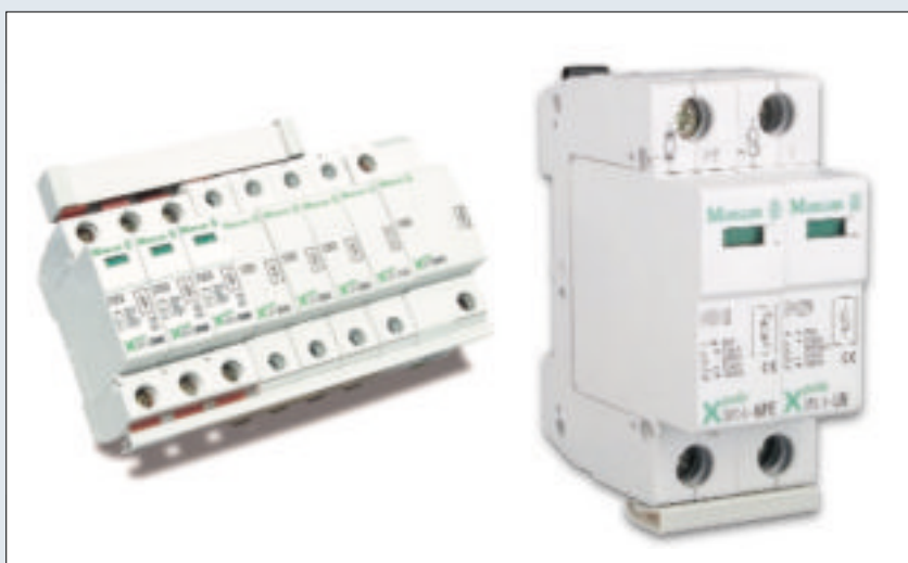
8 Ograniczniki przepięć: z lewej zestaw ograniczników klasy B+C, z prawej – ogranicznik klasy D, dodatkowe zabezpieczenie szczególnie czułych urządzeń elektrycznych (fot. Moeller Electric)
