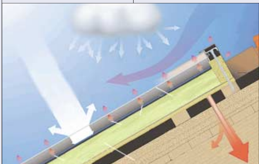
9 Przemiana energii w kolektorze (rys. Braas)
