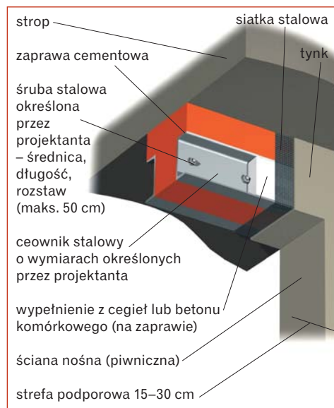
▲ Przykład wzmocnienia ściany w miejscu nadproża okiennego
