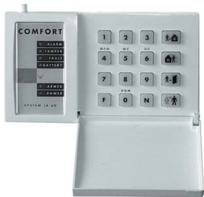
4 Systemy bezprzewodowe działają za pośrednictwem fal radiowych; na zdjęciu – centralka (fot. DPK System Consulting) ▲
