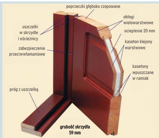
Przekrój przez drewniane drzwi wejściowe
