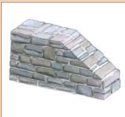
Mury warstwowe wznosi się z kamieni łupanych, sortowanych, w których powierzchnie są dość płaskie i w miarę równoległe do siebie. Muruje się je stosując zasady wiązania pospolitego (tak jak dla murów ceglanych)
