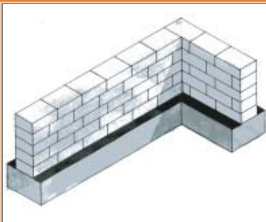
1 Ściana fundamentowa z pełnych bloczków betonowych
