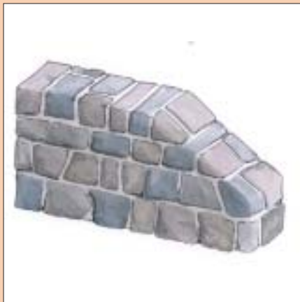
Mury rzędowe wykonuje się z kamieni łupanych o kształcie zbliżonym do regularnych kostek – poszczególne warstwy mają jednakową wysokość. Nadziemne części zwykle spoinuje się zaprawą cementową
