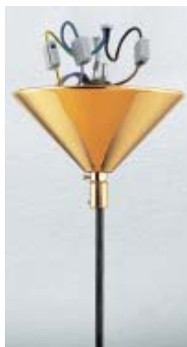
Złączka oświetleniowa standardowa i podwójna. Od strony instalacji od 1,0 do 2,5 mm 2 jednodrutowe. Od strony oprawy od 0,5 do 2,5 mm 2 linki i druty 400 V 24 A
