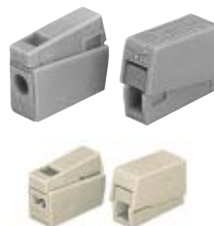
Złączka oświetleniowa standardowa i podwójna. Od strony instalacji od 1,0 do 2,5 mm 2 jednodrutowe. Od strony oprawy od 0,5 do 2,5 mm 2 linki i druty 400 V 24 A
