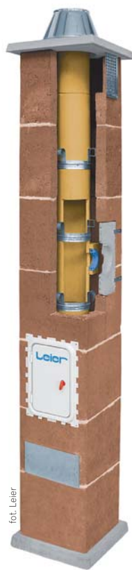
Prefabrykowany komin ceramiczny. Rurę tworzącą przewód kominowy wykonuje się z ceramiki szamotowej lub kamionki, obudową są zaś zwykle pustaki keramzybetonowe
