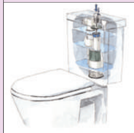
13 Przycisk dwudzielny umożliwia sflukiwanie – do wyboru – 3 lub 6 litrami wody
