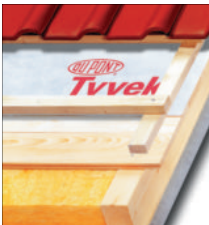
1 Folia dachowa wysokoparoprzepuszczalna nie wymaga pozostawiania szczeliny nad ociepleniem – może do niej bezpośrednio dotykać (fot. DuPont)
