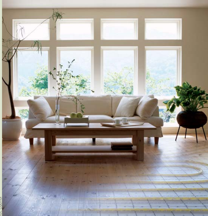
▲ Wodne ogrzewanie podłogowe najlepiej współpracuje z posadzkami dobrze przewodzącymi ciepło (ceramicznymi, kamiennymi)
