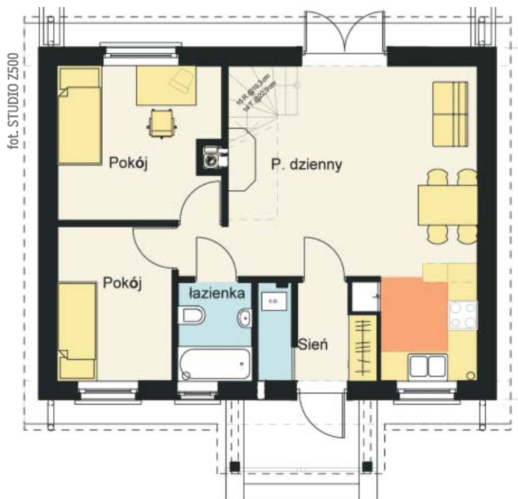
1.0 Sien jako śluza termiczna to jeden z ważniejszych elementów domu energooszczędnego
