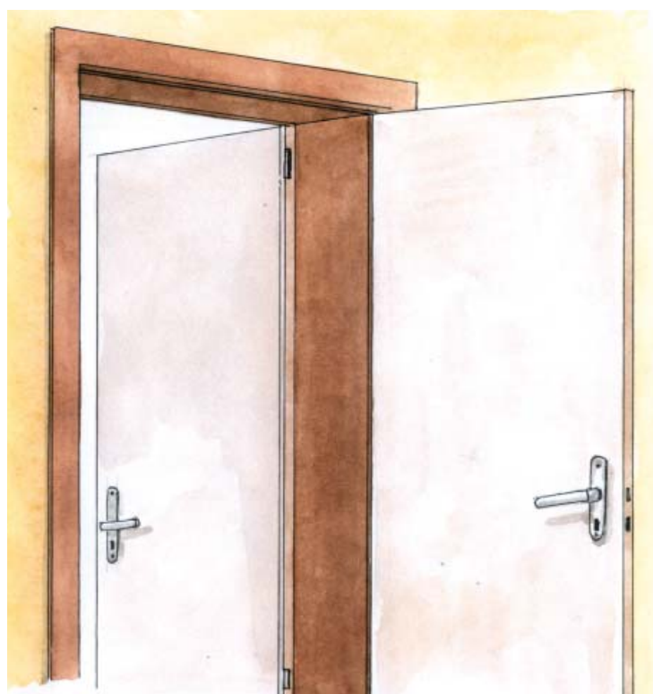
1.1 Podwójne drzwi w ścianie zewnętrznej to przykład radzenia sobie z nadmiernymi stratami ciepła
